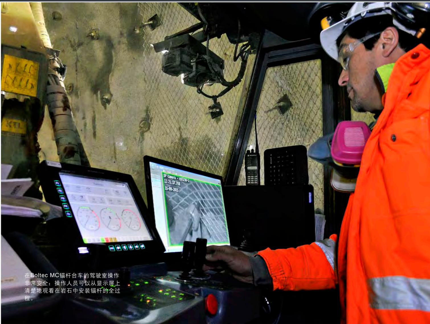
在Boltec MC锚杆台车的驾驶室操作非常安全：操作人员可以从显示屏上清楚地观看在岩石中安装锚杆的全过程。
