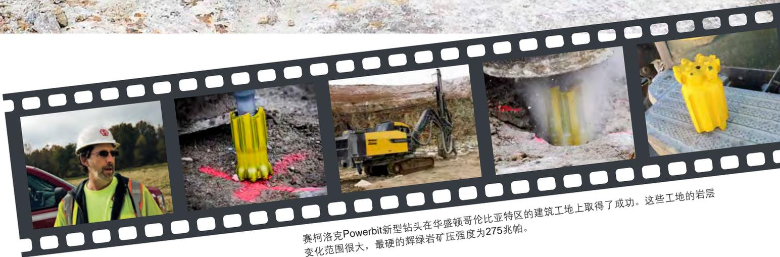
赛柯洛克Powerbit新型钻头在华盛顿哥伦比亚特区的建筑工地上取得了成功。这些工地的岩层变化范围很大，最硬的辉绿岩抗压强度为275兆帕。
