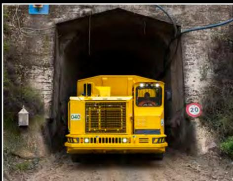
越大越好：60吨级的Minetruck MT6020矿用卡车提高了Aljustrel矿的运输能力和生产率。
