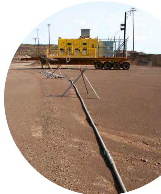
移动电缆和钻机的代价高昂：将电缆移动到一个新的爆破地点可能需要数小时，而将一台电动钻机移动到一个新的爆破地点至少需要一天的时间。
