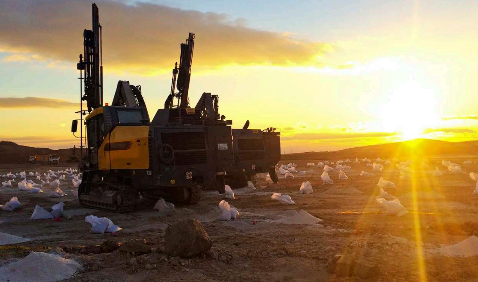
该矿在测试Powerbit钻头时，使用了阿特拉斯·科普柯SmartROC T35和FlexiROC T35钻机，钻进的炮孔深度5.5米。每一台钻机使用的都是102毫米Powerbit T51钻头。这种钻头采用了易返式设计，镶嵌了球形HD钻齿（右图）。
