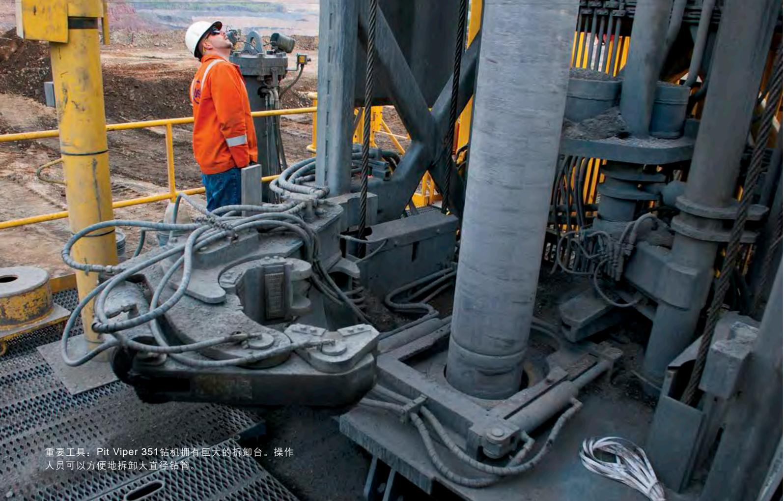
重要工具：Pit Viper 351 钻机拥有巨大的拆卸台。操作人员可以方便地拆卸大直径钻管。
