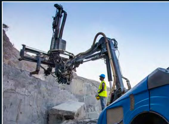
**SpeedROC 2F**，珍珠矿业公司最新购买的阿特拉斯·科普柯石材开采设备。这种遥控钻机配置了两台液压凿岩机，用于钻进水平孔和垂直孔。加长钻臂可360°旋转，作业范围宽，能提高生产率。该钻机凿岩速度快、钻孔精度高，具有卓越的定位和行驶能力。除尘系统过滤面积为11平方米，空气过滤能力为720立方米/小时。确保了采石场作业环境的清洁。
